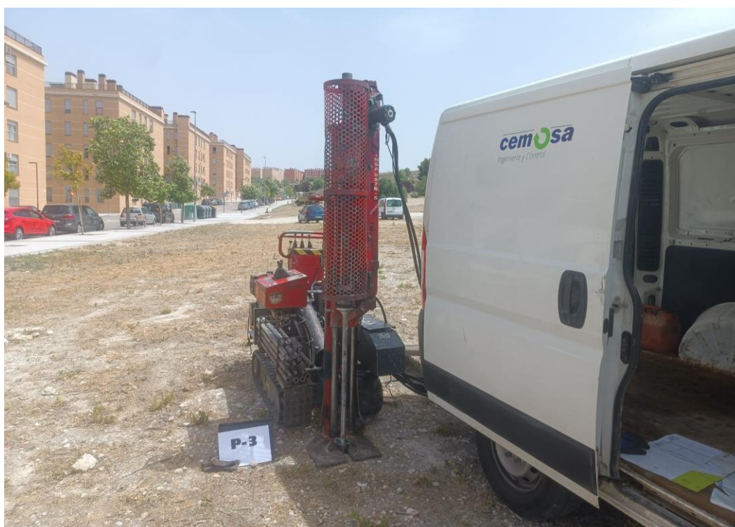
Figura Nº 12.- Trabajos para la realización de la penetración dinámica, tipo DPSH, referida como P-03.
