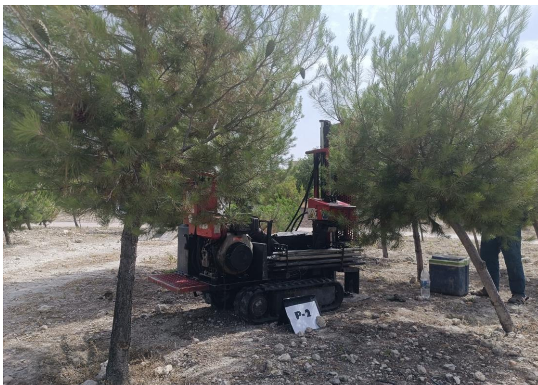
Figura Nº 11.- Trabajos para la realización de la penetración dinámica, tipo DPSH, referida como P-02.
