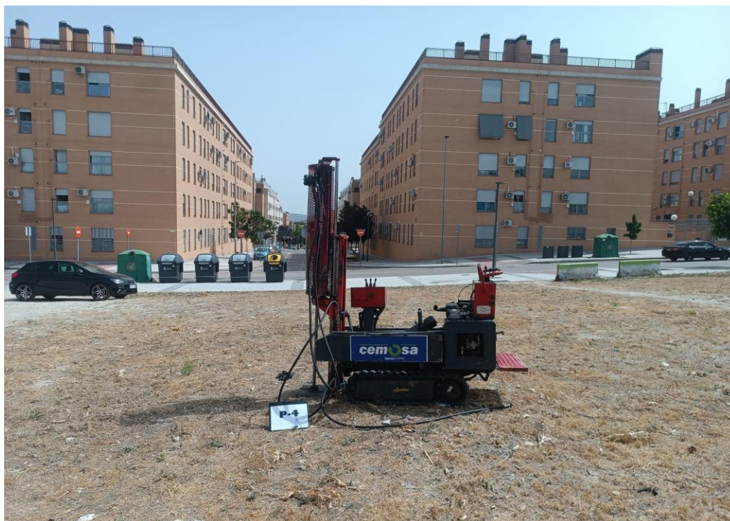
Figura Nº 13.- Trabajos para la realización de la penetración dinámica, tipo DPSH, referida como P-04.
